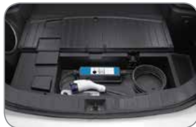
جایگاه کابل شارژ
